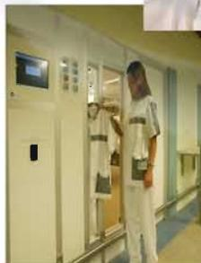
Armarios dispensador de ropa con sistema Rfid.
